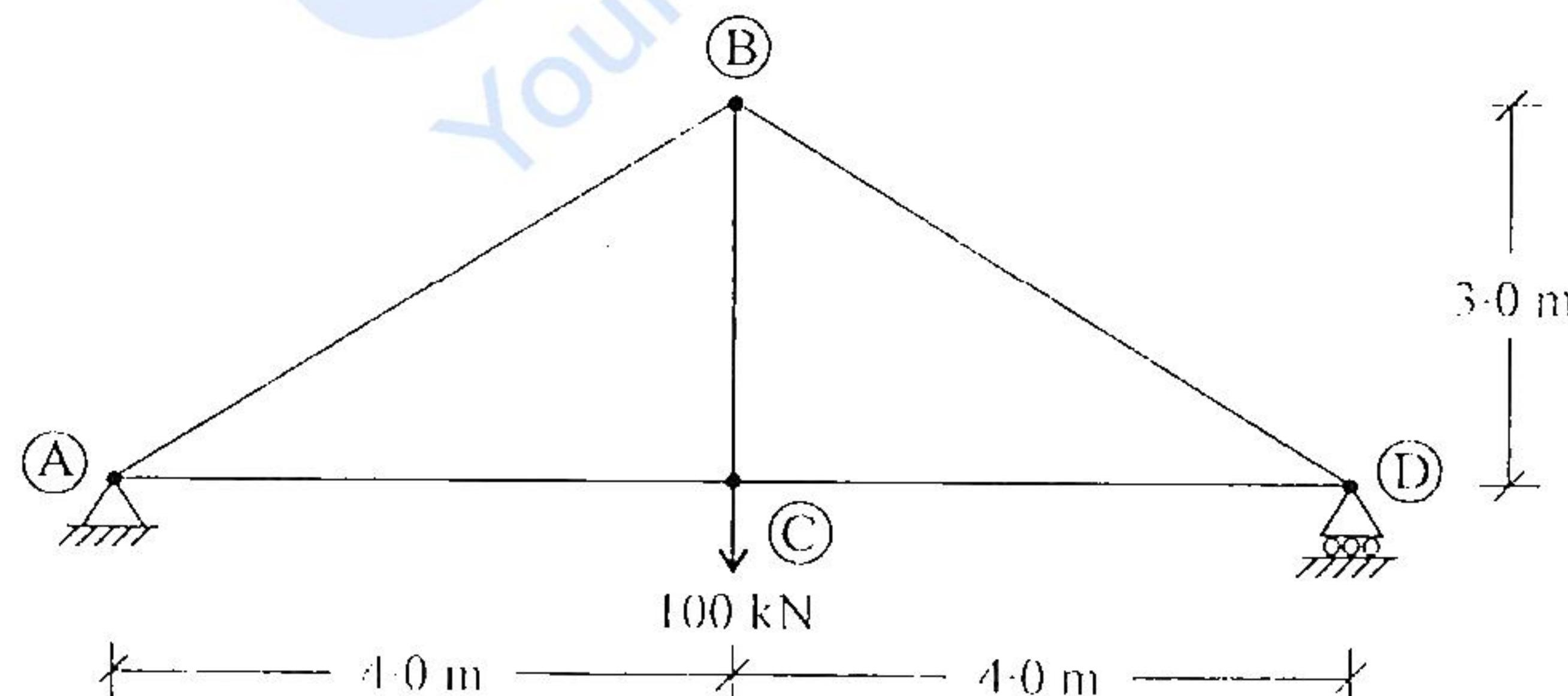
ऊपर दिये गये चित्र में प्लेन ट्रस (कैंची) के जोड़ B के लिए ऊर्ध्वाधर विक्षेपण का परिकलन पूर्कल भार विधि के द्वारा कीजिए। ट्रस के सभी अवयव समांगी अनुप्रस्थ-काट पर्याप्त वाले हैं। Calculate the vertical displacement of joint B of plane truss given in the above figure by unit load method. All members of truss have constant cross-sectional area and same material (Constant A & E).
